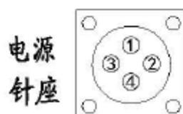
① 脚为接地接地，②③接电源
